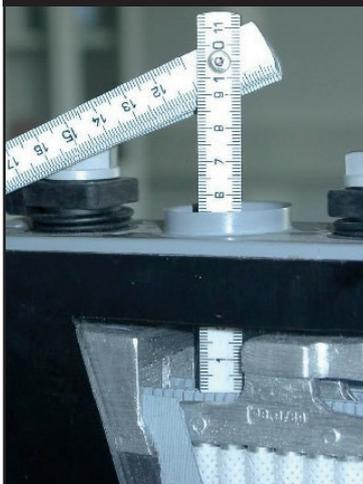
Mit dem Meterstab vom Zellenkragen bis auf die Scheider messen (nicht zwischen die Platten sondern quer zu den Scheidern).
